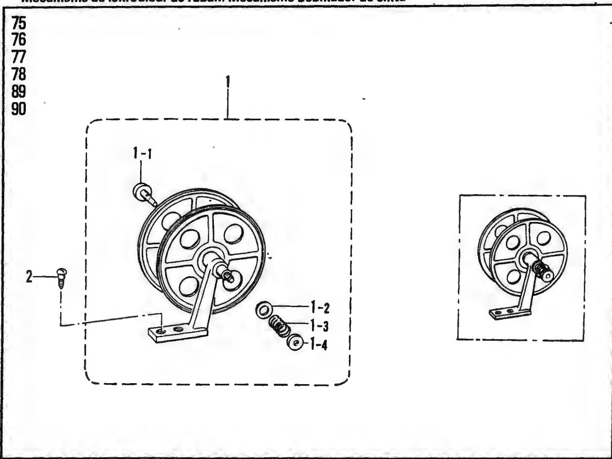
Q. ラッパー関係/Lapper mechanism/Falz-Mechanismus/
