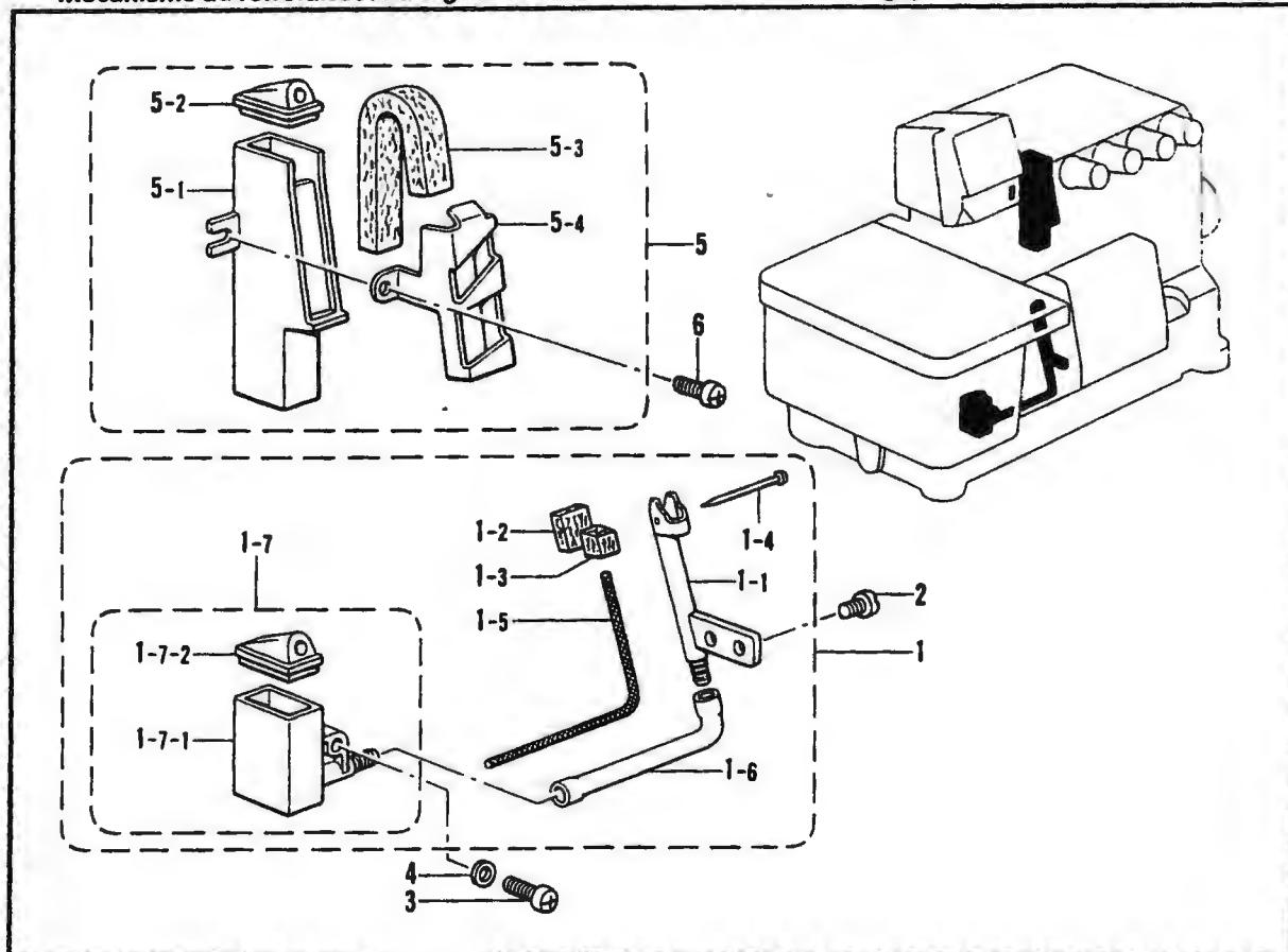
N. 线导装置 / Gimp guide mechanism / Schnurführung /
