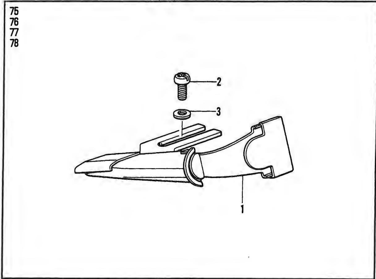
P. テープワインター関係 / Tape winder mechanism / Bandaufwickelvorrichtung/
