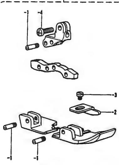
レ. ペンタ脚部 / Presser foot mechanism / Mécanisme du pied presseur / Mecanismo del prensa telas
