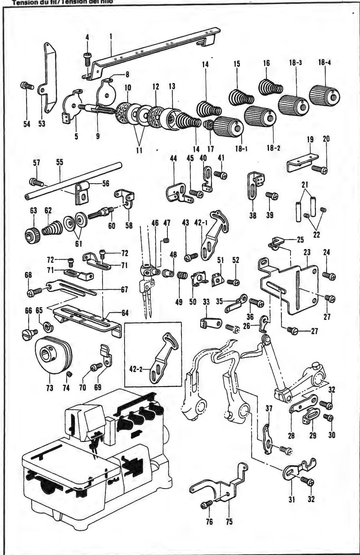
L. 線調子関係 / Thread tension / Fäuerspannung /
