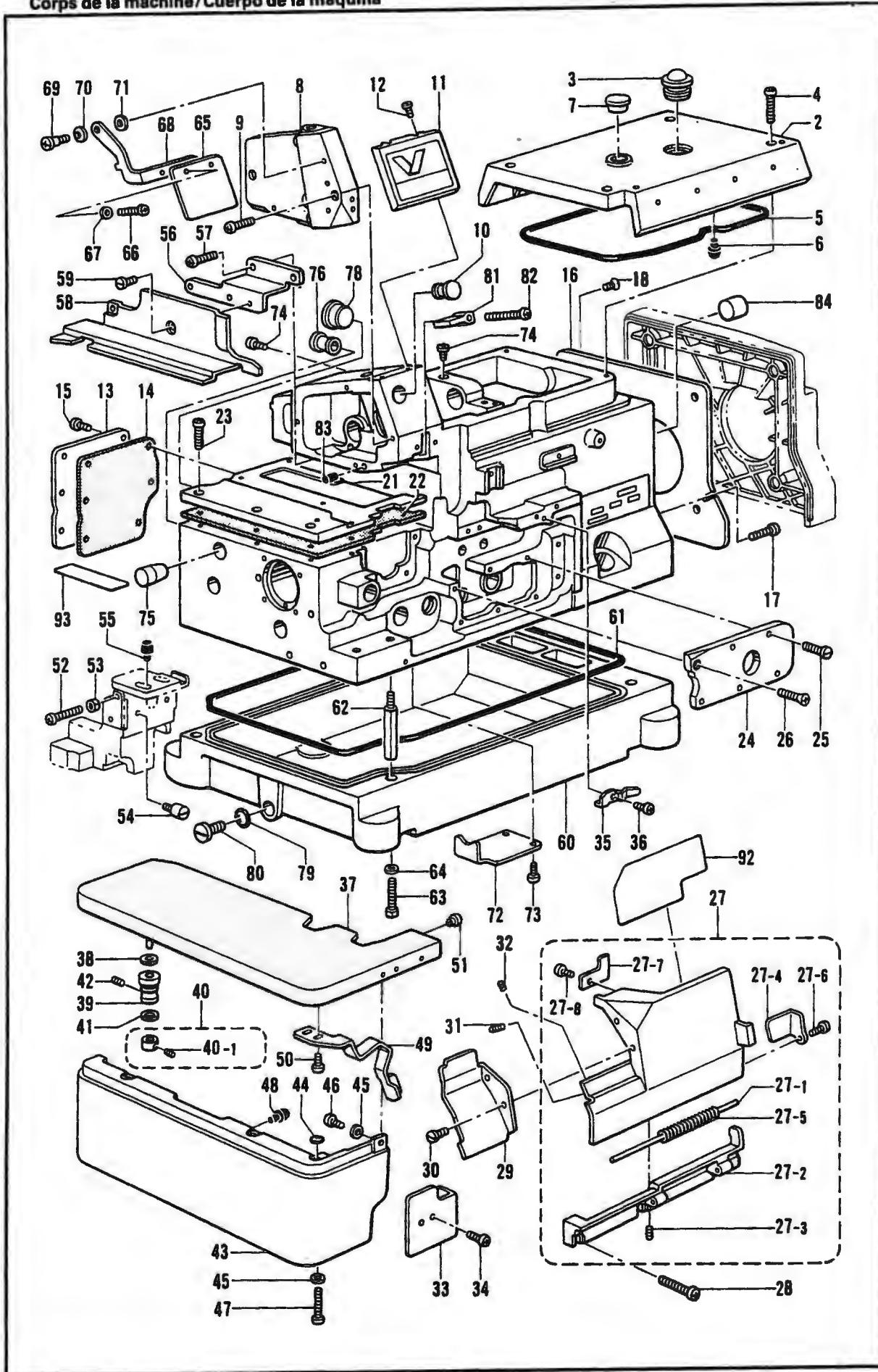
A. ノレーム部品 / Machine body / Mecanismo de máquina
