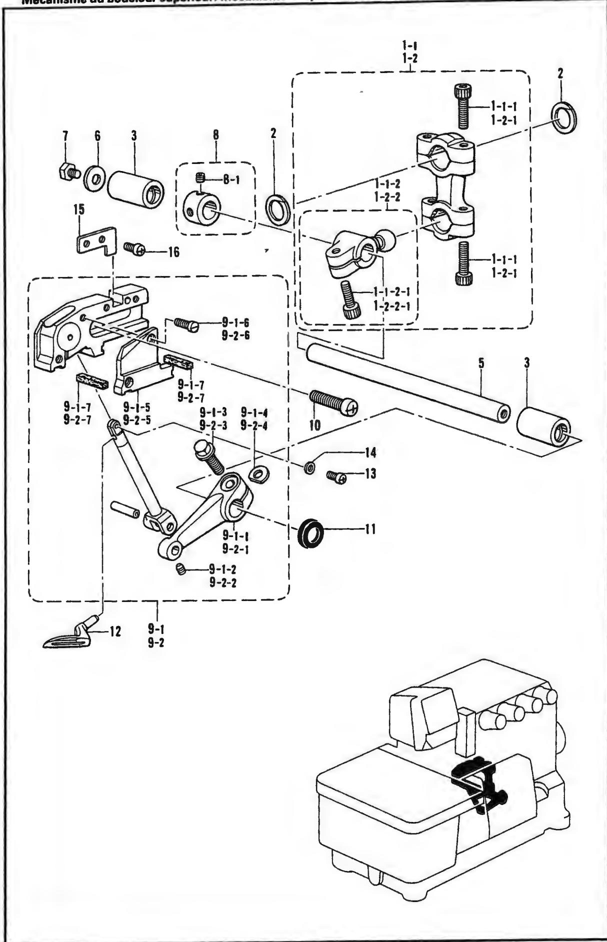
④ 上ルーハイローパー / Over looper mechanism / Mécanisme du boucleur supérieur / Mecanismo del presilladora superior
