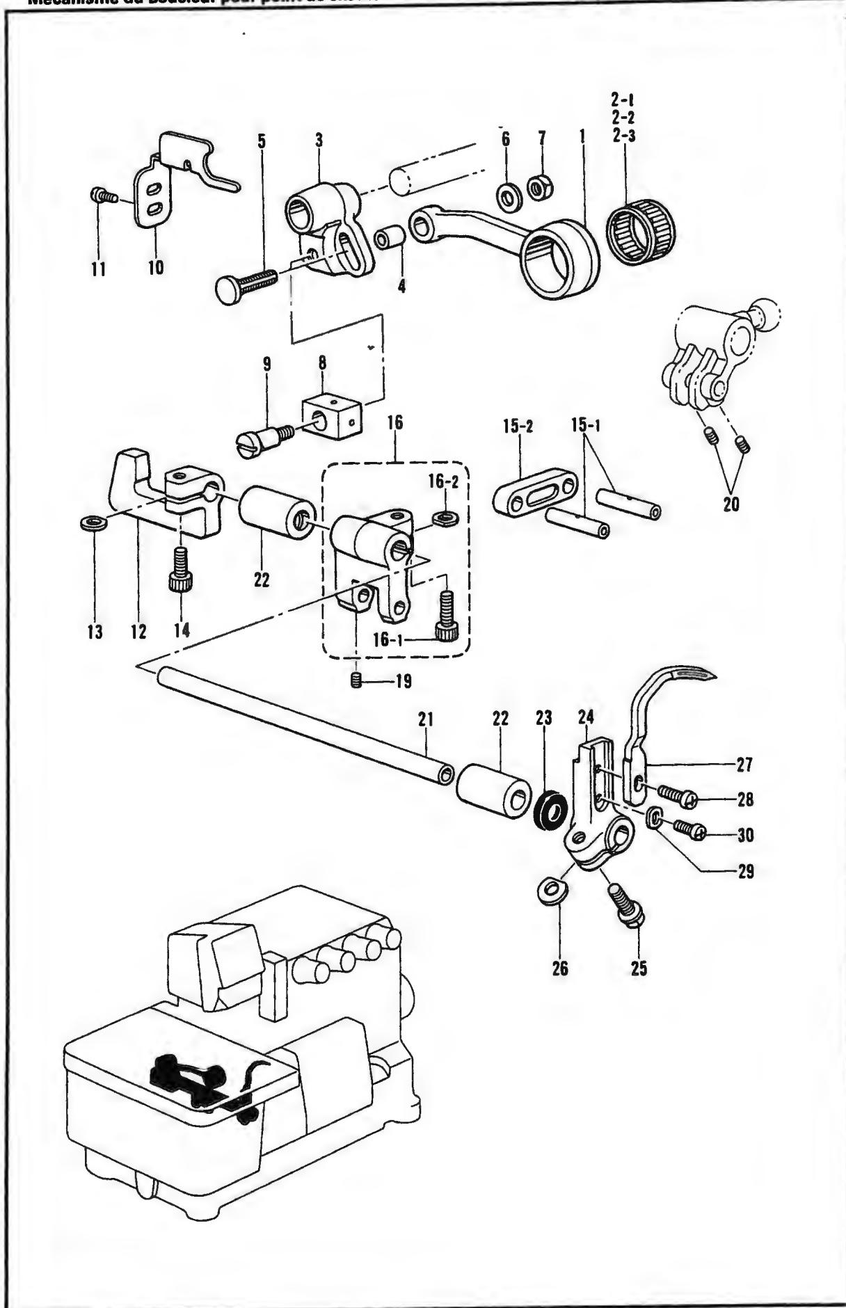
Mécanisme du boucleur pour point de chaînette double/Mecanismo del presilladora de doble cadeneta
