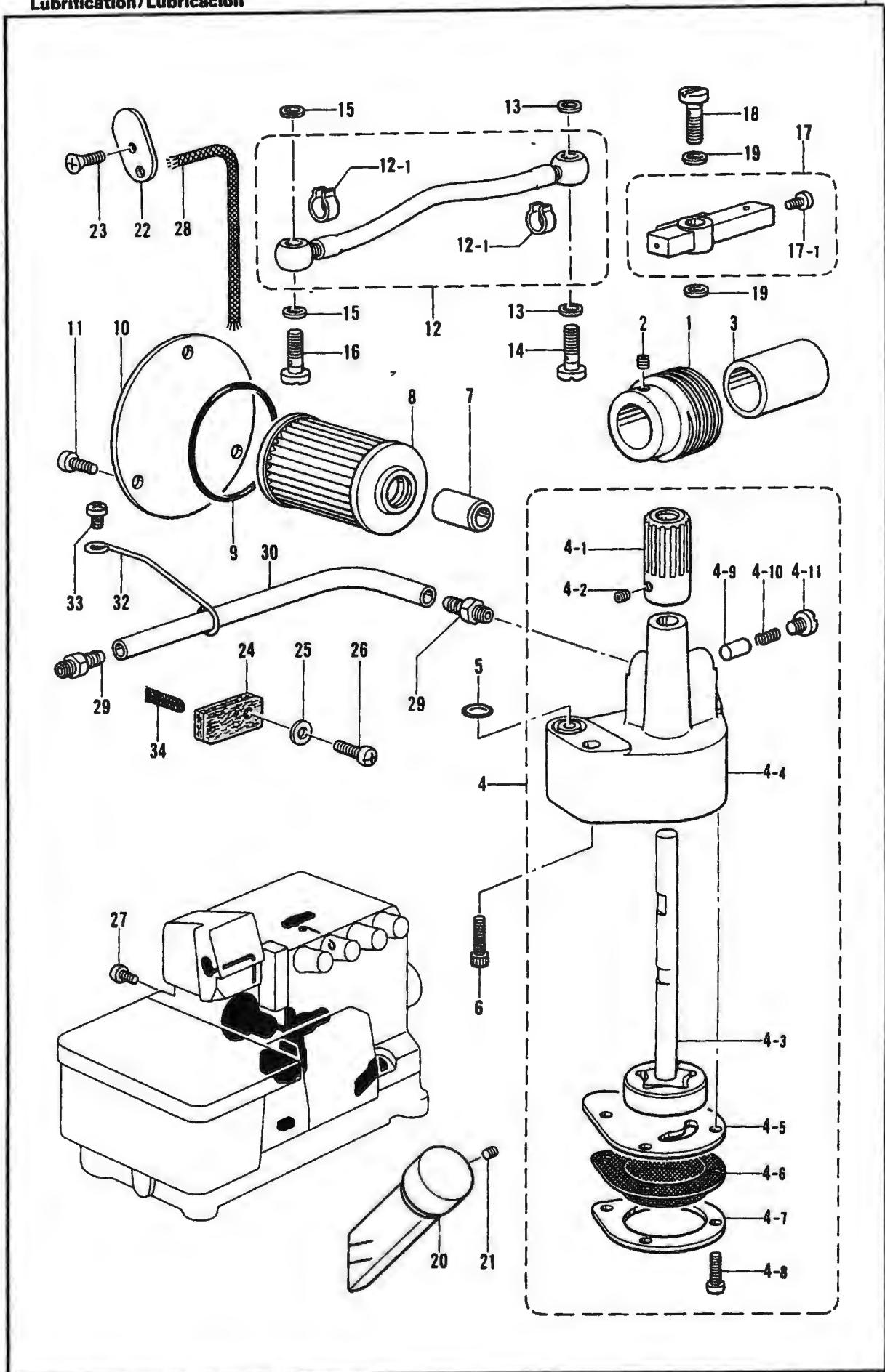
八. 润滑部品表 / Lubrication/ Lubricación
