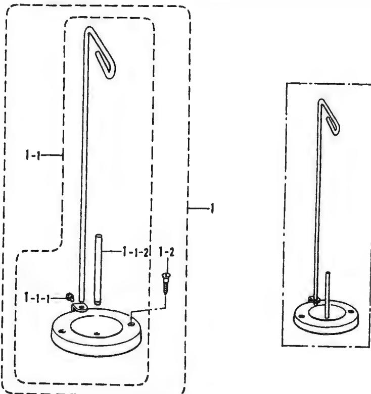
M. 針冷却装置 / Needle cooler / Nadelkühlungsvorrichtung/
