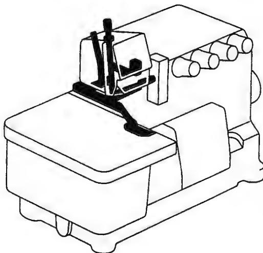
U. 滝工関係 / Presser foot mechanism / 斜面機関部
