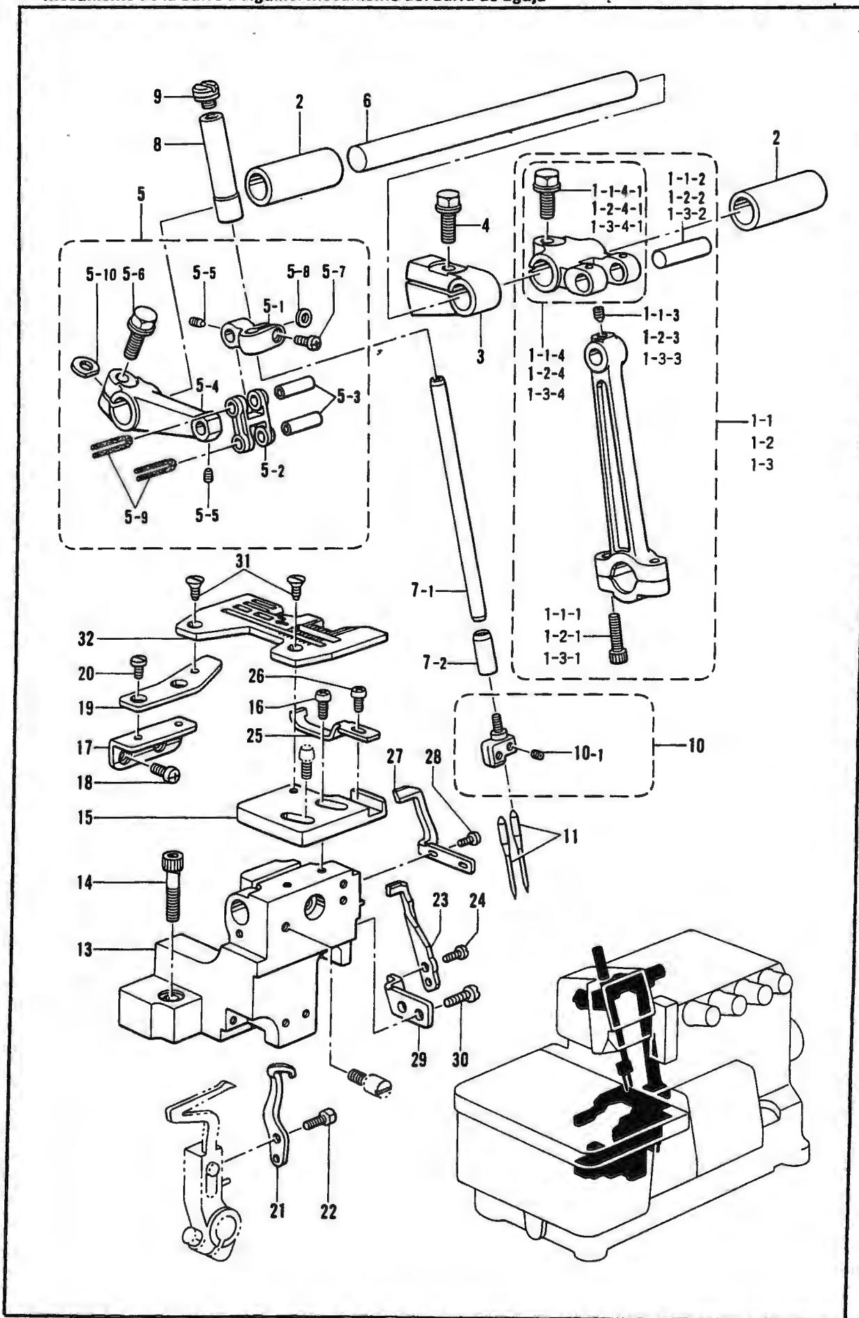
C. 针杆机构 / Needle bar mechanism / Nadelstangenvorrichtung /
